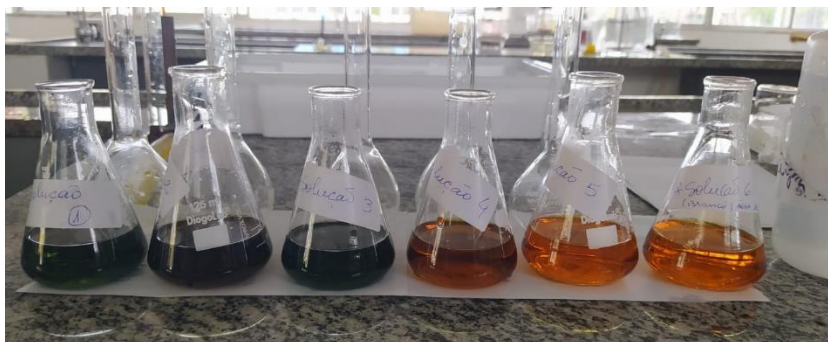
Figura 6. Teste para quantificar o teor de carbono nas soluções diluídas com para curva padrão de glicose. Coloração verde para presença do carbono (esquerda) e laranja ausência do carbono (direita).
